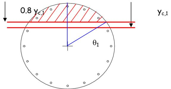
Quanto alle tensioni nelle armature, bisogna valutarne la deformazione per l'assegnata posizione dell'asse neutro  $y_c$ ; in questo modo è possibile risalire alle corrispondenti tensioni ed alle loro risultanti.
