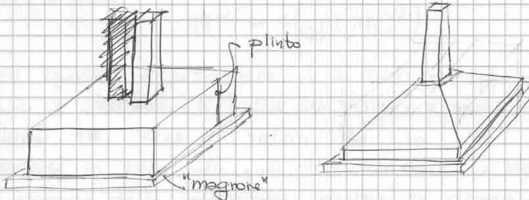
Nel caso generale il pilastro alla base è sollecitato dalle caratteristiche  $N, T$  ed  $H$ . I valori corrispondenti delle sollecitazioni sul piano di posa della fondazione possono stimarsi come segue per tener conto delle peso del plinto e della sua altezza:
