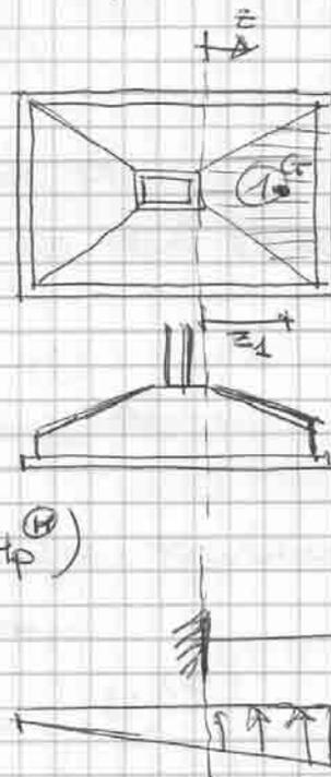
delle pressioni sul terreno. Tale sezione è posta in corrispondenza dell'attacco tra pilastro e plinto ed ha ~~dimensione~~ una larghezza pari alla metà del plinto ai piedi del pilastro ed altra pari ad  $H_p$ .
