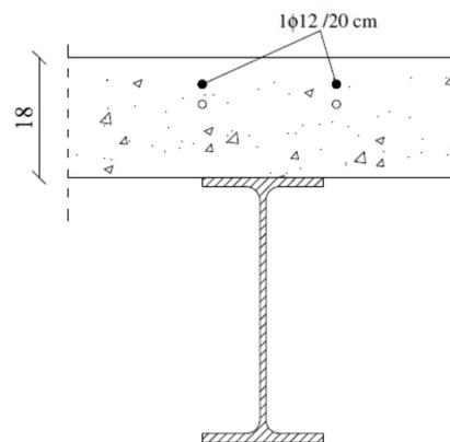
**Fig. 2 - Sezione trasversale della trave (IPE 400)**
