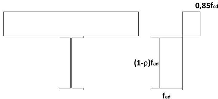
Fig. 5 - Riduzione della resistenza per tenere conto della presenza del taglio
