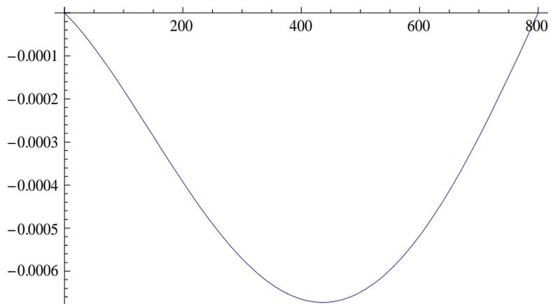
**Fig. 6 - Funzione abbassamento della trave**
