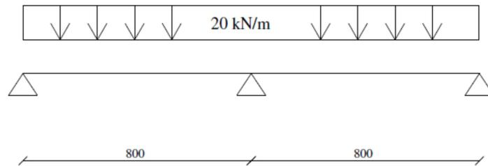
**Fig. 1 - Schema statico della trave**
