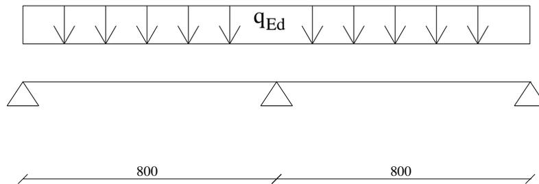
Figura 1: schema statico della trave in oggetto
