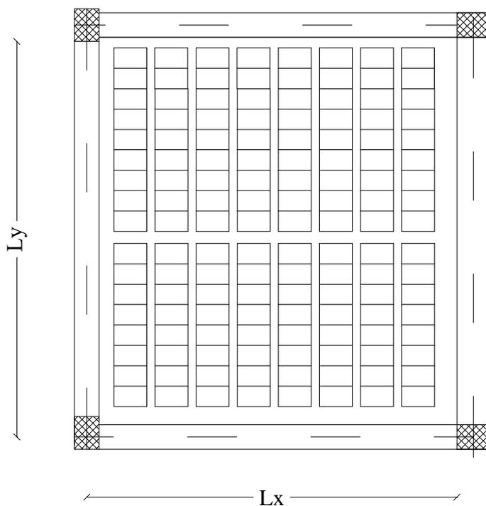
Assumendo la condizione di semplice appoggio lungo il perimetro del solaio, se ne determinino le sollecitazioni tramite il modello di piastra ortotropa ed una soluzione ottenuta tramite Serie Doppie di seni.
