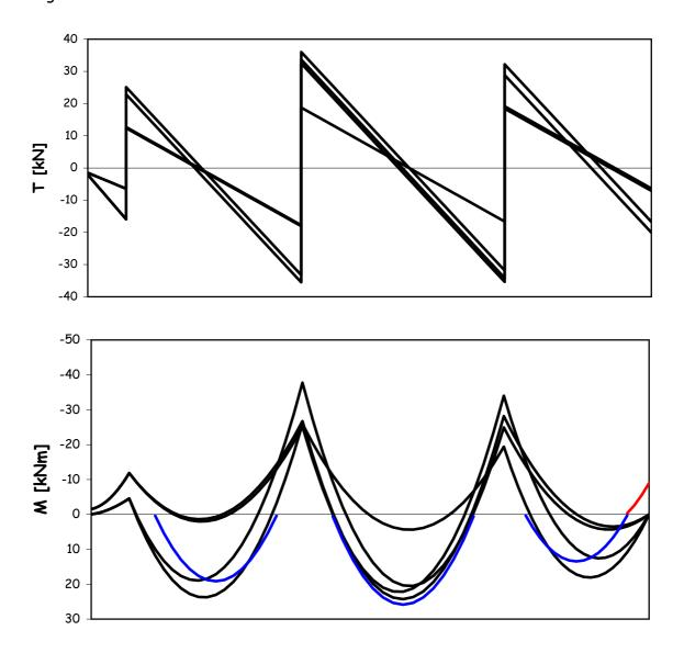
Per i momenti flettenti, oltre ai quattro diagrammi sovrapposti, sono stati riportati alcuni tratti di parabola per tener conto del fatto che le travi esercitano sulle singole campate delle azioni di semincastro. Il momento negativo sull'appoggio D (tratto in rosso) viene valutato come  $p_3L_3^2/24$ , mentre le parti a momento positivo sono tracciate come rami di parabola con un valore in appoggio pari a  $p_iL_i^2/16$  (e, dunque, lo stesso valore in mezzeria).
